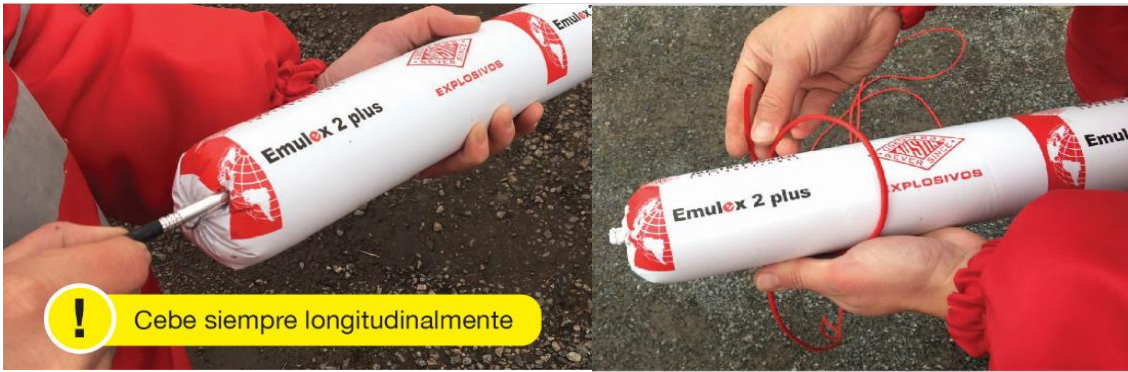
Fig. 3: Insertar el detonador hasta que esté completamente enterrado en el centro del cartucho
