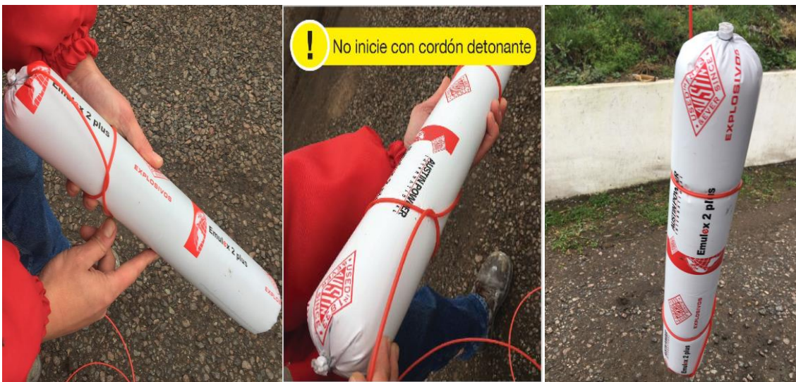
Fig. 5: Tirar el tubo a través de los nudos
