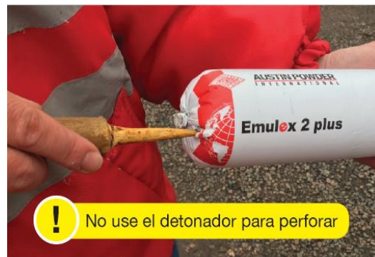
Fig. 2: Realizar un agujero axial en el centro del cartucho con el uso del punzón
