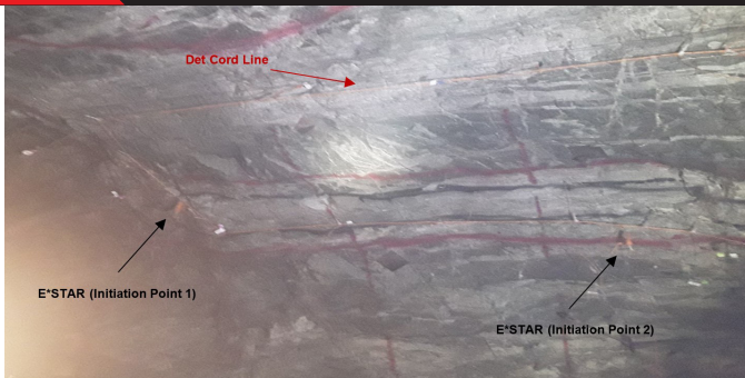
Fig. 3: Conexión entre pozos y el cordón detonante
